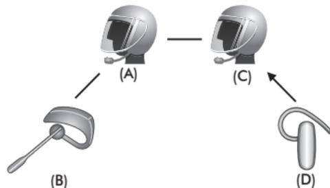
4. Désormais deux LINKIN Ride Pal III (A & C) et deux d'autres fabricants (B & D) sont connectés par l'intercom universel à quatre.
